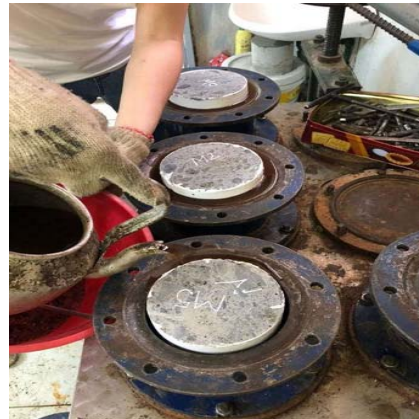
Hình 7: Thí nghiệm thử thấm
