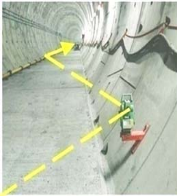
Hình 1.3: Lưới đường chuyền kép trong hầm
