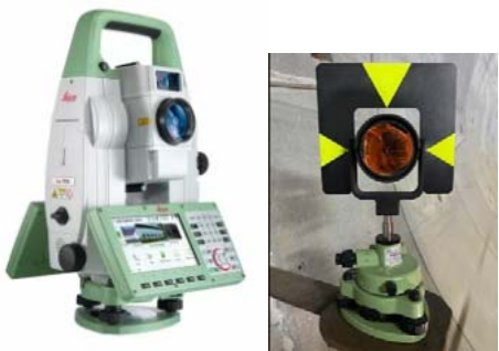
Hình 3.1: Máy toàn đạc điện tử TS16-1 và thiết bị dọi tâm quang học
