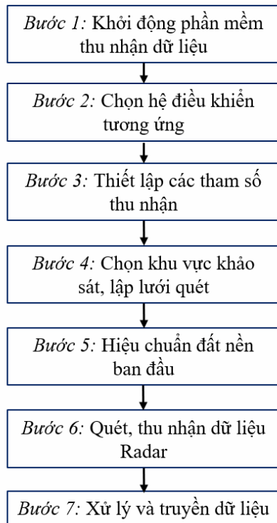
Hình 5: Quy trình vận hành trong thử nghiệm hiện trường GPR
