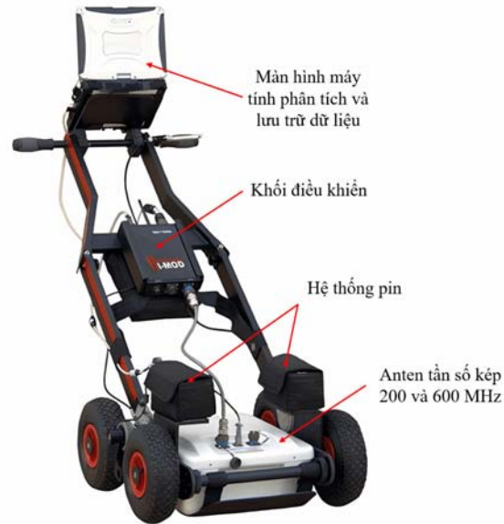
Hình 2: Cấu tạo hệ thống Radar xuyên đất IDS tần số kép (200 - 600 MHz) [12]
