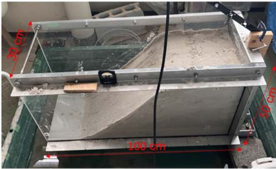
Hình 6: Đối tượng mô hình mái dốc thí nghiệm
