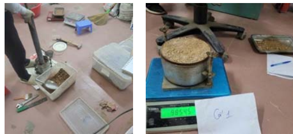
Hình 6: Đầm nén lần lượt mẫu vật liệu ở các độ ẩm đã chế bị trước đó
