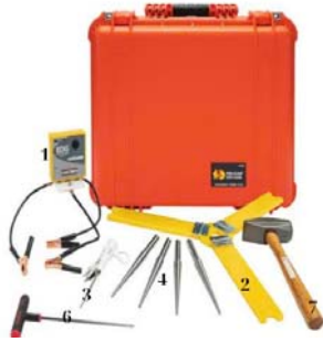
Hình 3: Thiết bị đo EDGe-H-6500F.3F hiện trường
