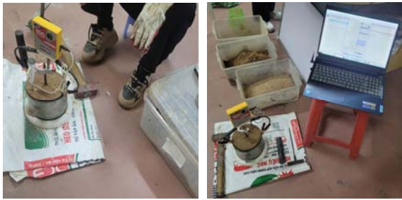
Hình 7: Lắp đặt bộ cảm biến EDG trong phòng - kết nối với phần mềm EDG trên Windows
