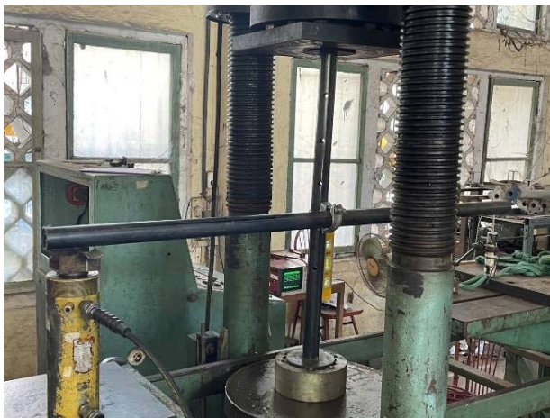
Hình 3: Hình ảnh thử nghiệm khoá giáo góc vuông
