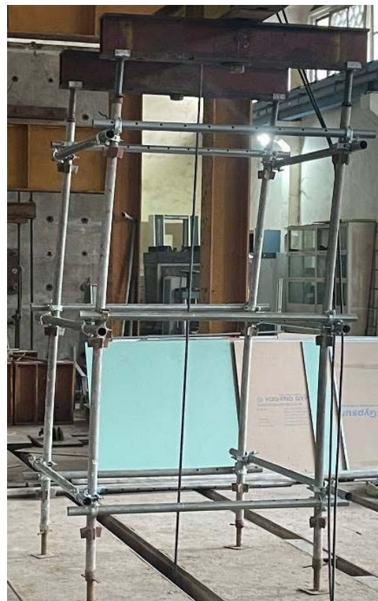
Hình 9. Thử tải giáo chống sử dụng khớp giáo góc vuông liên kết ống thép rời
