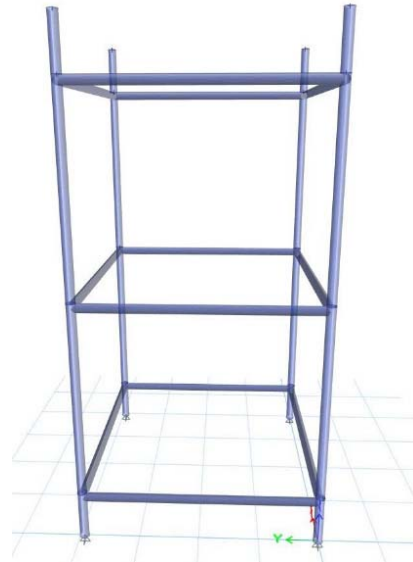
Hình 9. Mô hình tính hệ kết cấu chống đỡ tạm
