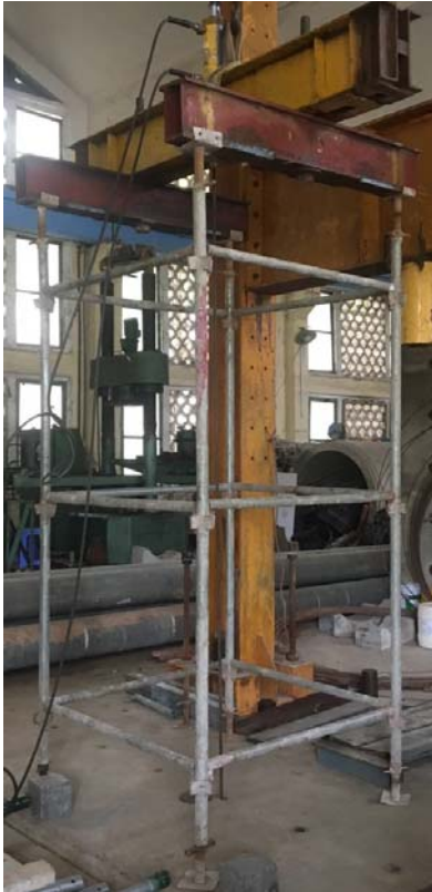
Hình 10. Thử tải giáo nêm có cùng kích thước
