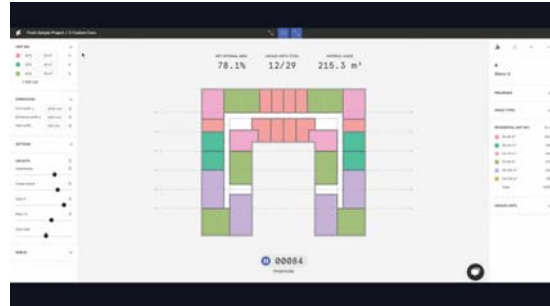
Hình 1: Giao diện Finch 3D - Generate Floor Plate (Custom Core): AI sinh mặt bằng tầng chữ U, NIA 78,1%, 12/29 căn; panel trái chỉnh Unit Mix/kích thước/trọng số, panel phải theo dõi cơ cấu căn và chỉ số; Iterations: 84.
