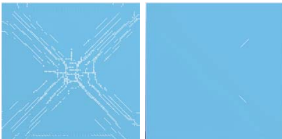
Hình 17: Phá hoại mặt dưới tấm BTCT: tấm dãn lực 3 mm (trái), tấm dãn lực 5 mm (phải), các tấm dãn lực 7 và 9 mm tấm BTCT không bị phá hoại
