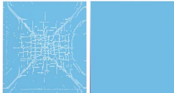
Hình 13 : Phá hoại mặt dưới tấm BTCT: tấm chịu trực tiếp (trái), tấm có bộ hấp thụ (phải)
