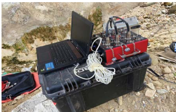
Hình 2: Bộ thiết bị BDI trong công tác khảo sát, kiểm định cầu Bản Hiệu, Điện Biên
