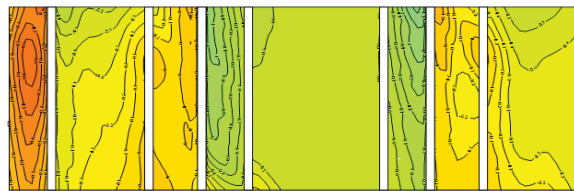
Hình 12: Phân bố C_p trên các mặt của mô hình với tiết diện hình chữ H
