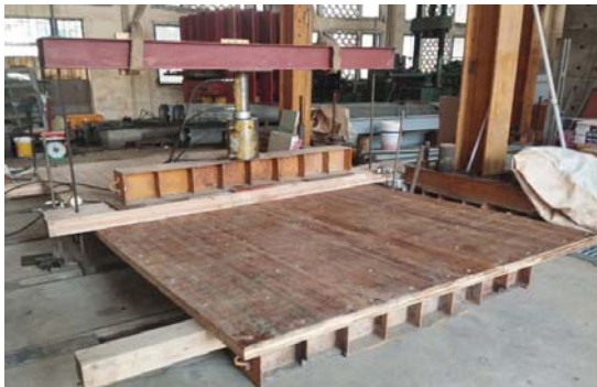
Hình 11: Ảnh thử nghiệm uốn thực tế trong phòng thí nghiệm
