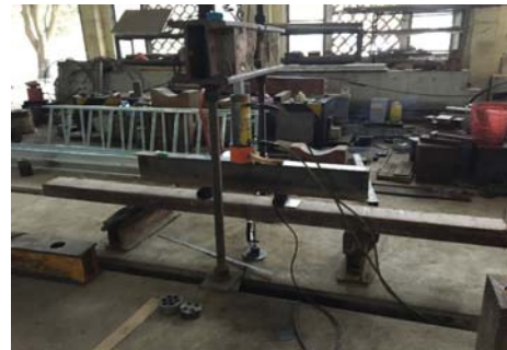
Hình 5: Ảnh thử nghiệm uốn thực tế trong phòng thí nghiệm
