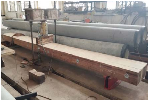
Hình 7: Ảnh thử nghiệm uốn dầm liên kết thanh vít thực tế trong phòng thí nghiệm
