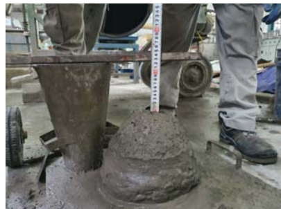
Hình 1: Thí nghiệm độ sụt của HHTB
