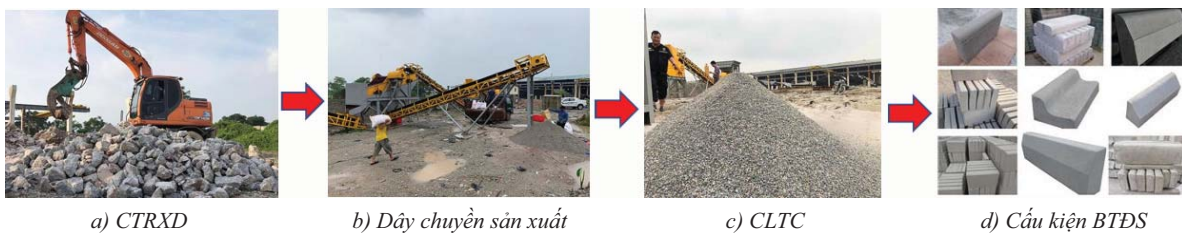
Hình 1: Quy trình sản xuất từ CTRXD đến cầu kiện BTĐS
