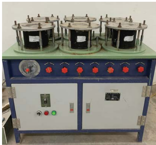
Hình 9: Thí nghiệm độ thấm nước dưới áp lực thủy tĩnh 150 kPa trong 07 ngày theo tiêu chuẩn BS EN 14891:2017
