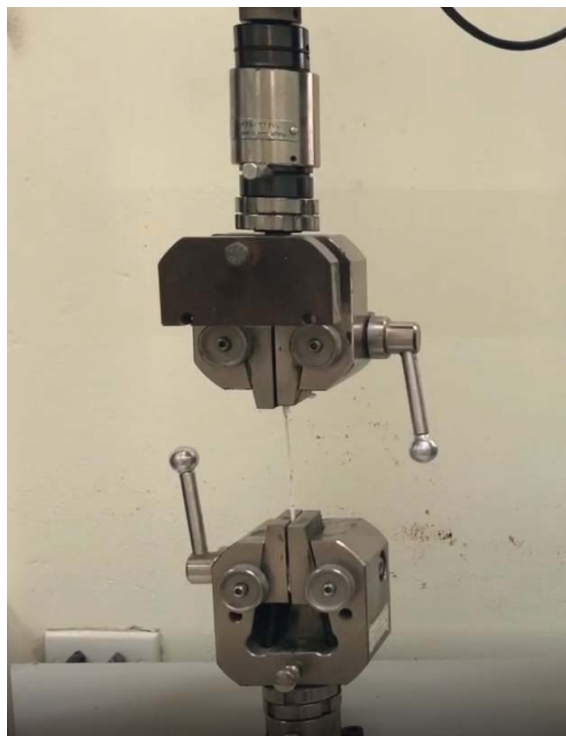
Hình 11: Thí nghiệm kiểm tra cường độ kéo và độ giãn dài khi đứt
