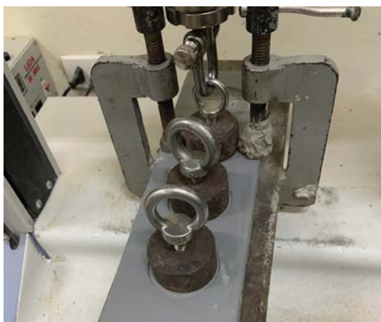
Hình 8: Thí nghiệm cường độ bám dính theo BS EN 14891:2017
