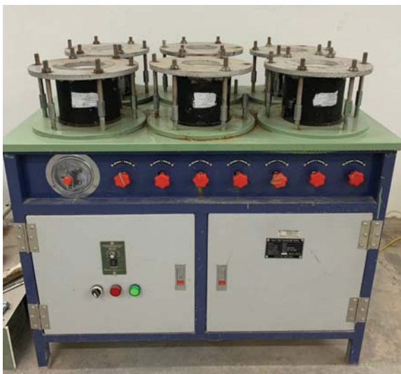
Hình 5: Thí nghiệm độ thấm nước dưới áp lực thủy tĩnh 150 kPa trong 07 ngày theo tiêu chuẩn BS EN 14891:2017
