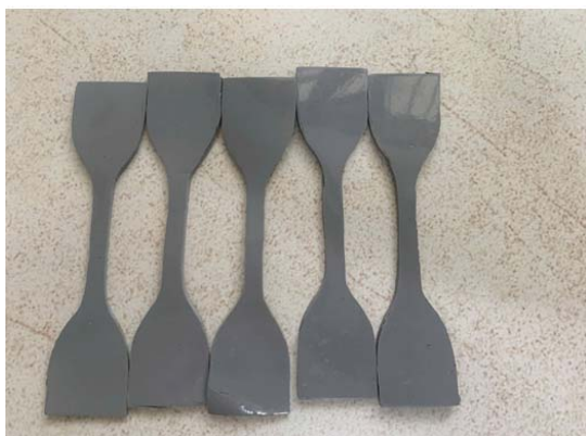
Hình 6: Mẫu thí nghiệm cường độ kéo và độ giãn dài khi đứt của sản phẩm gốc PU theo ASTM D412-16
