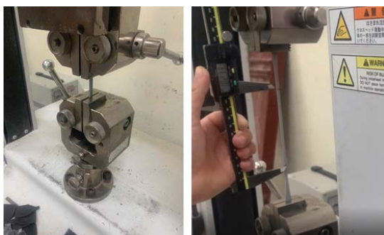
Hình 7: Thí nghiệm cường độ kéo và độ giãn dài khi đứt theo ASTM D412-16
