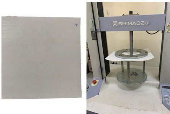
Hình 12: Mẫu và thí nghiệm khả năng chống đâm thủng theo ASTM E154/E154M-08a (2019)
