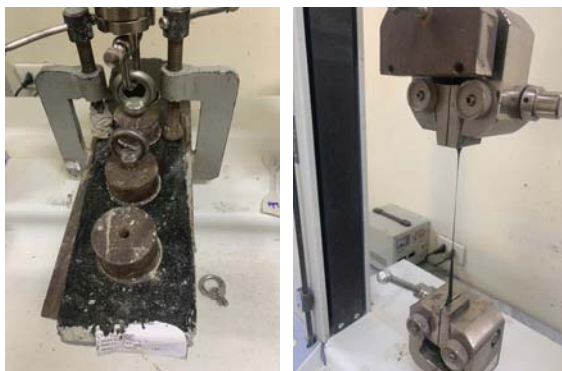
Hình 2: Thí nghiệm kiểm tra cường độ bám dính và độ giãn dài khi đứt
