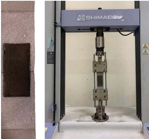
Hình 3: Mẫu và thí nghiệm đánh giá khả năng tạo cầu vết nứt của sản phẩm theo tiêu chuẩn BS EN 14891:2017
