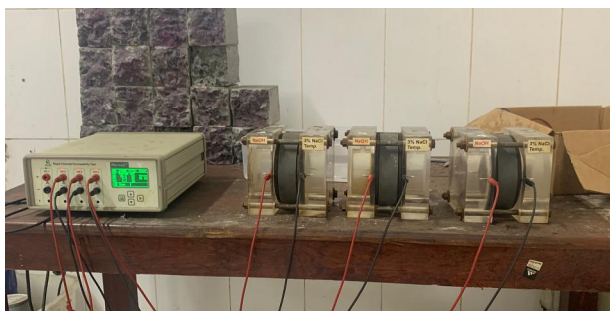
Hình 15: Sơ đồ thí nghiệm hệ số thấm ion clo của vữa vi sinh
