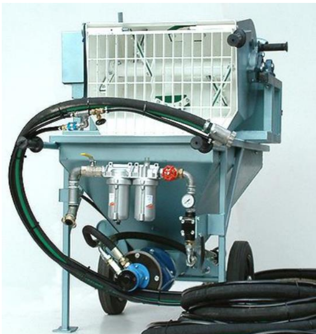
Hình C.2. Máy trộn - phun
