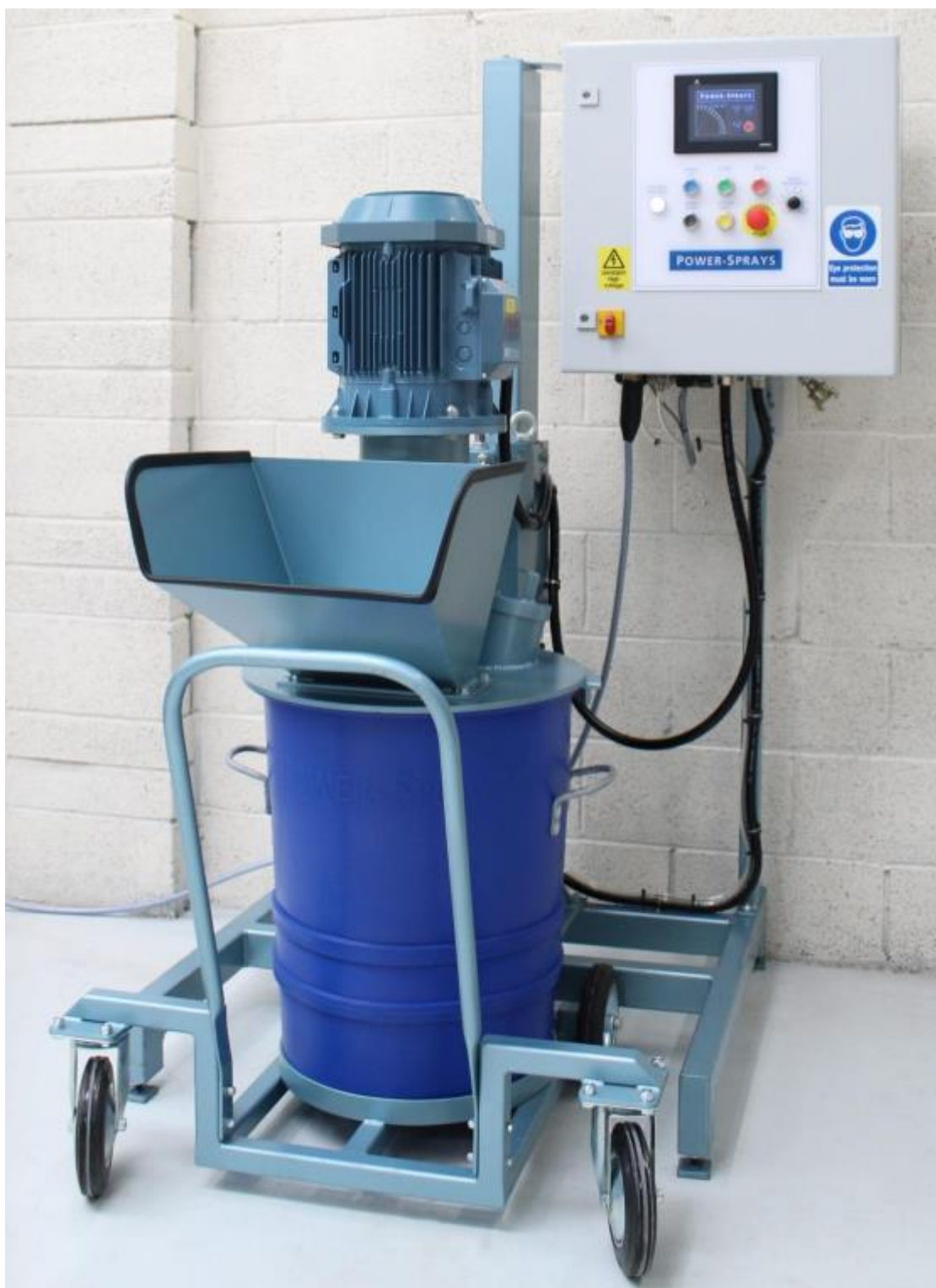
Hình C.8. Máy trộn 2 tốc độ
