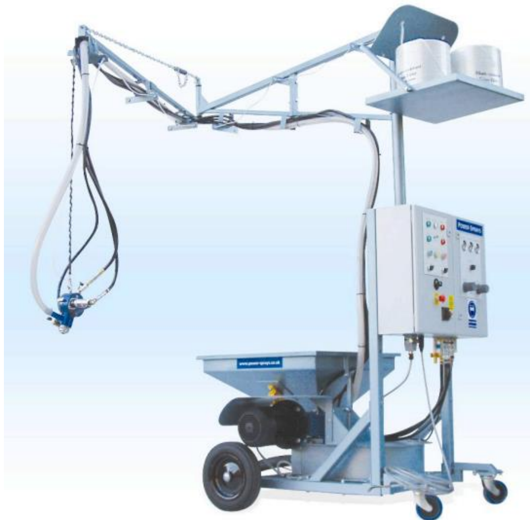
Hình C.1. Trạm trộn phun đồng thời
