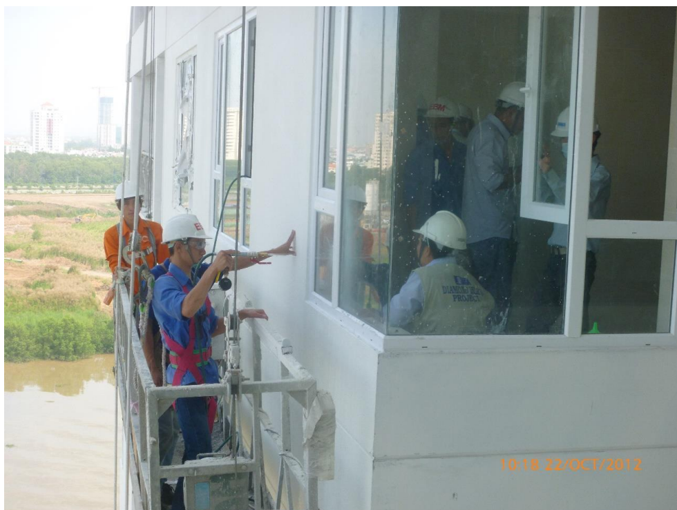
Hình 10. Thử nghiệm độ lọt nước tại hiện trường
