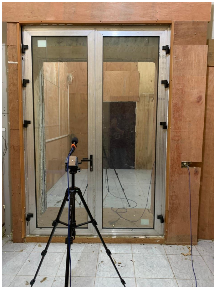
Hình 12. Thử nghiệm đo cách âm trong phòng lab
