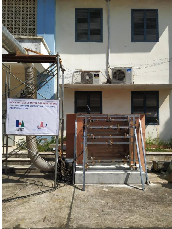
Hình 14. Thử nghiệm khả năng chịu lực áp lực gió cho mẫu lan can
