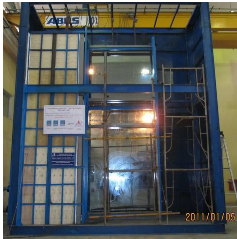
Hình 1. Thử nghiệm hệ mặt dựng nhôm kính của công trình "Tòa nhà PV GAS" (Hồ Chí Minh)
