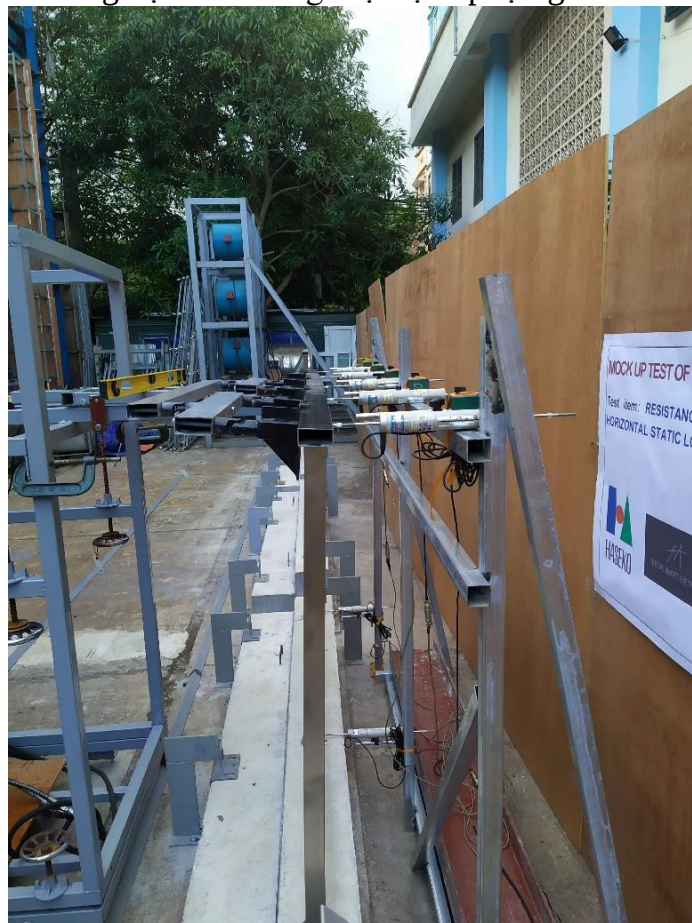
Hình 15. Thử nghiệm khả năng chịu lực của hệ tay vịn lan can
