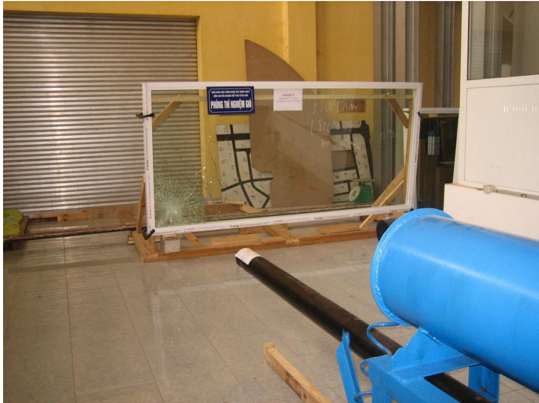
Hình 11. Thử nghiệm khả năng chịu lực bằng vật thể bay
