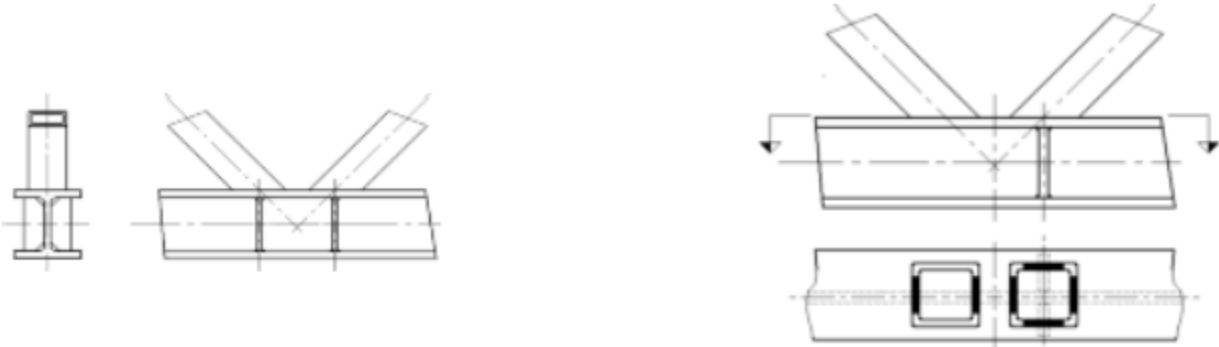
Chu vi hiệu dụng thanh giằng, không có (trái) và có (phải) sườn gia cường
