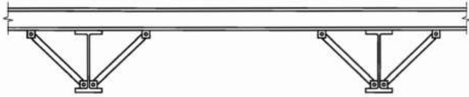
Hình 6.5 – Liên kết cứng chống xoắn điển hình
