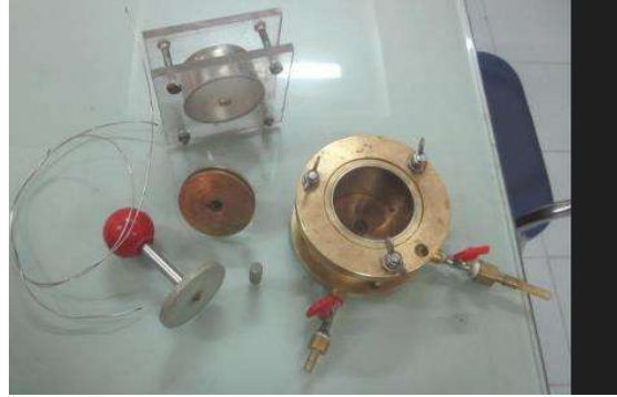
Hình 1.12. Thiết bị hộp nén hướng tâm (NCKHT) kiểu Rowe
