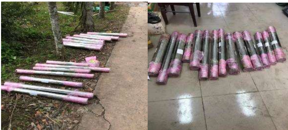
Hình 3.3. Các mẫu được lấy lên từ hố khoan
