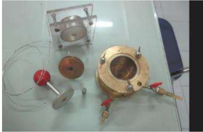
Hình 1.12. Thiết bị hộp nén hướng tâm kiểu Rowe [9]
