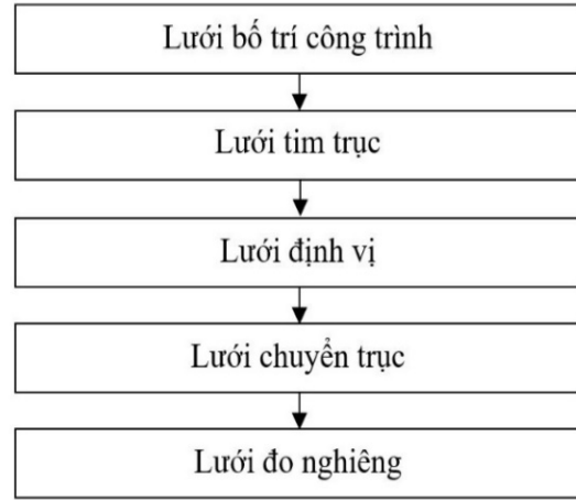
Hình 3. Lưới không gian một cấp xây dựng qua các giai đoạn
