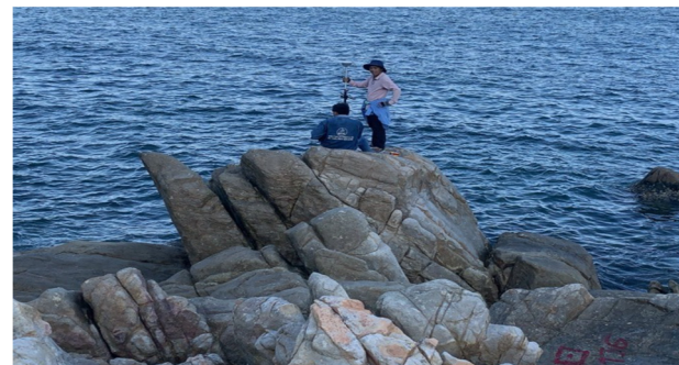
Hình 4. Đo nối khống chế ảnh và đo kiểm tra các điểm địa hình
