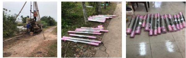
Hình 1. Công tác khoan và lấy mẫu tại hiện trường
