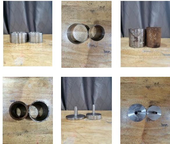
Hình 4. Ảnh chụp các dao vòng và dụng cụ phụ trợ được chế tạo
