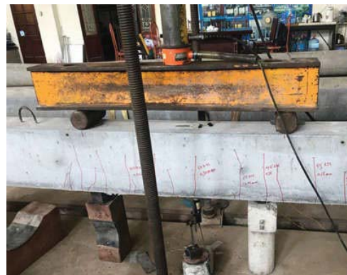
Hình 10. Uốn dầm BTCS tại cấp tải 60 kN
