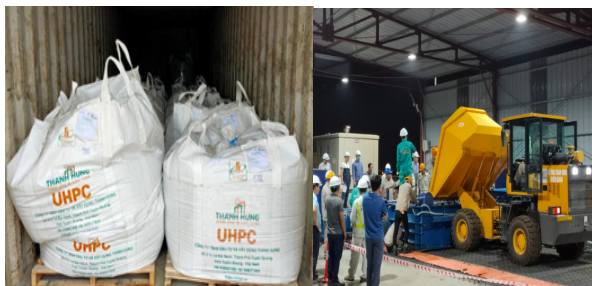
Hình 10. Bột khô UHPC trộn sẵn và máy rải - đầm - cán liên hợp
