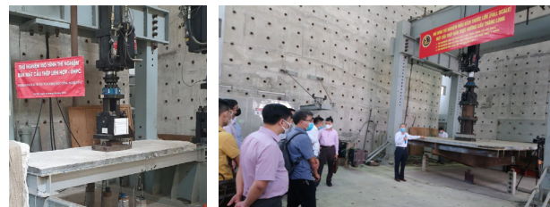
Hình 3. Mô hình nhỏ và lớn thử nghiệm lớp UHPC liên hợp bản mặt thép trực hướng
