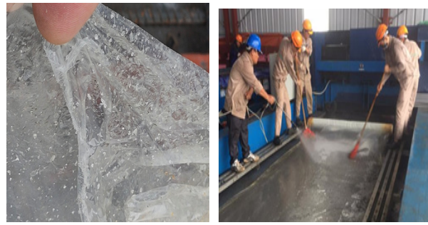
Hình 5. Thực hiện phủ màng film PVC có chứa các hạt silicagen lên bề mặt UHPC
