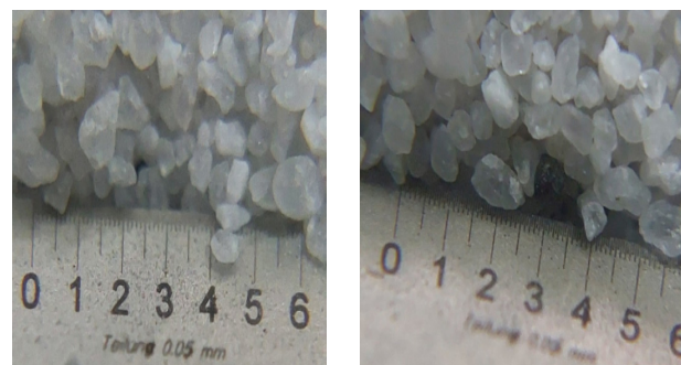
Hình 2. Hình ảnh cát mài nhìn qua kính phóng đại
