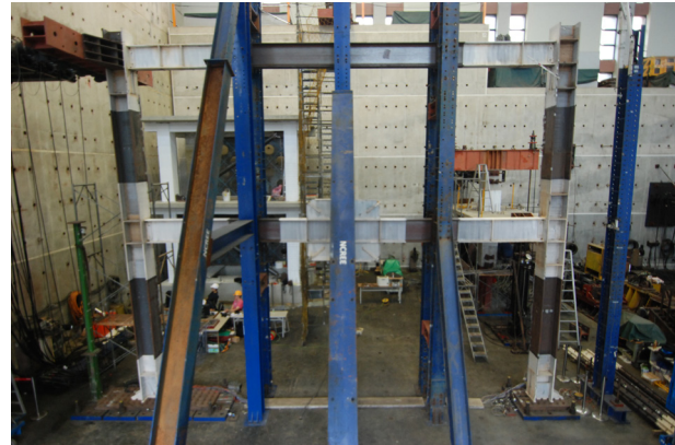
(d) MRF test (1.2% second floor drift)
