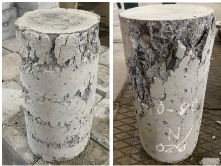
Hình 14. Dạng phá hoại của các mẫu bó (từ trái sang là mẫu 5 vành và 3 vành)
