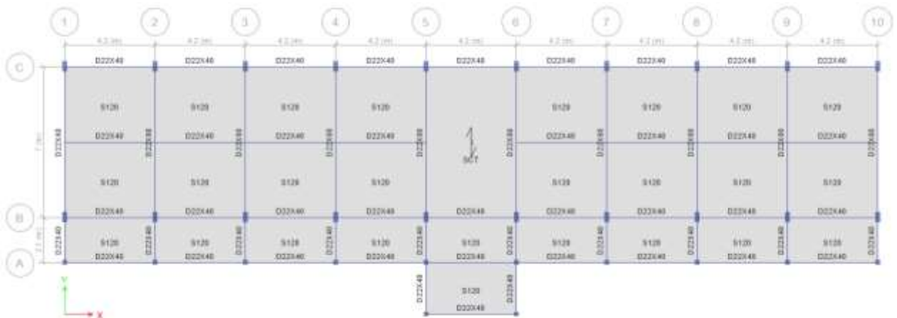
Hình 4.18-Mặt bằng mô hình kết cấu tầng 2
