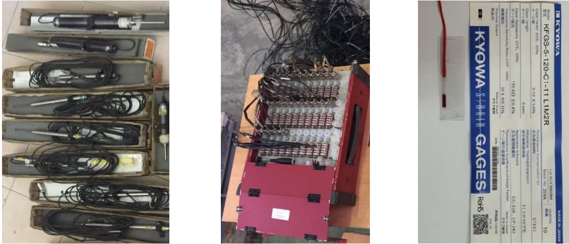
Hình 3.7. Các dụng cụ đo và bộ thu số liệu
