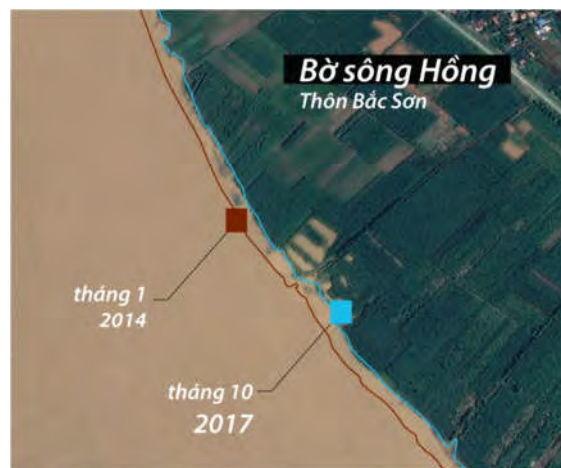
Hình 2.8 Xói lở bờ do khai thác cát [41]
