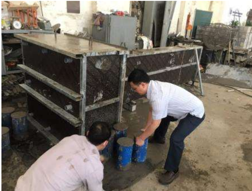
Đúc mẫu thí nghiệm bê tông
