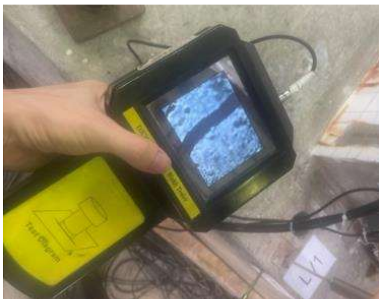
Hình 3.20. Thiết bị đo bề rộng khe nứt
