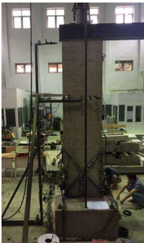
Hình 3.10. Lắp dựng mẫu thí nghiệm tại phòng thí nghiệm
