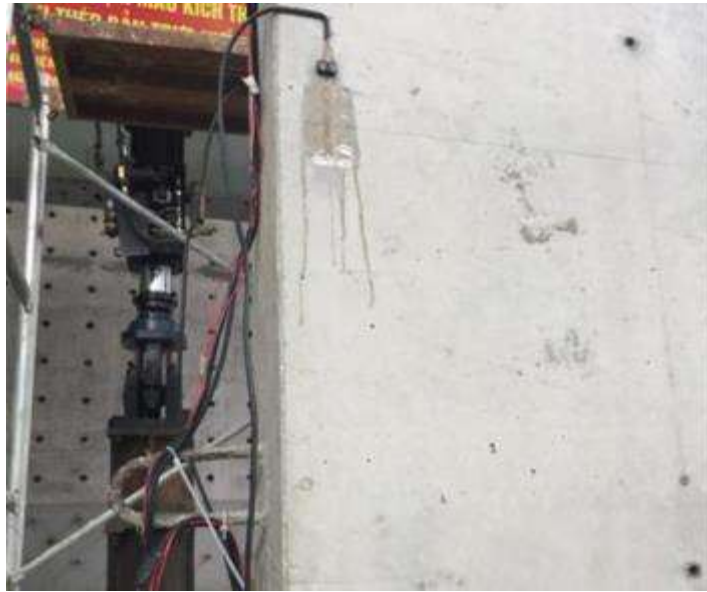
Hình 3.18. Vị trí các phiến điện trở đo biến dạng bê tông mẫu 1
