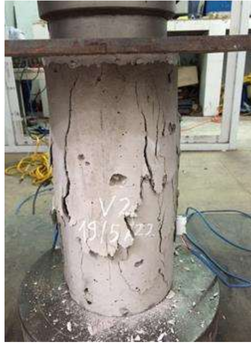
Thí nghiệm nén bê tông
