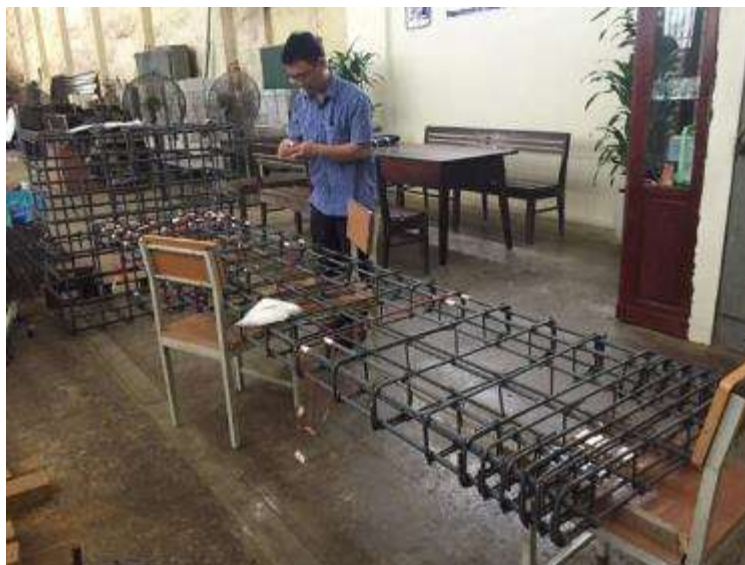
Đánh số các phiến đo biến dạng trong cốt thép
