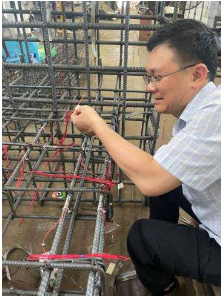
Dán các phiến đo biến dạng trong cốt thép
