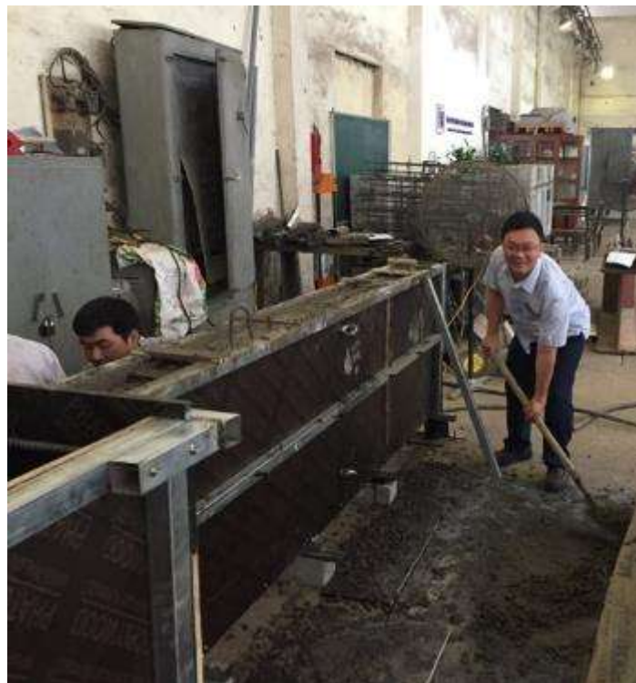
Đổ bê tông mẫu.
