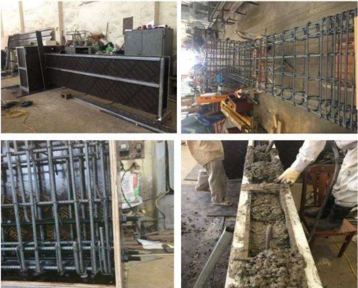
Hình 3.7 Chi tiết chế tạo mẫu
