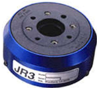
Hình 4.5. Thiết bị JR3 và ký hiệu chiều cho 6 thành phần lực
