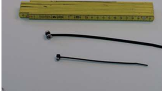
Hình C.2 – Các dụng cụ tạo xung khác nhau cho các kích thước mẫu khác nhau
