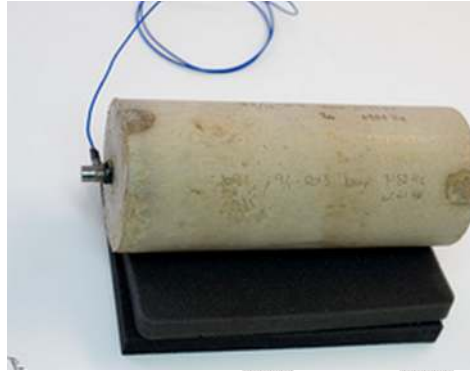
Hình C.3 – Mẫu được đặt trên xốp mềm để bảo đảm giảm chấn nhỏ nhất
