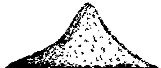
Hình F.2 - Cốt liệu hơi ẩm, đã quan sát thấy sụt đáng kể
