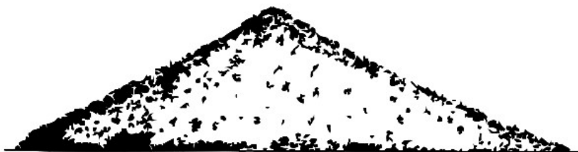
Hình F.3 - Cốt liệu đã đạt trạng thái bão hòa nước khô bề mặt, hầu như đã sụt hoàn toàn nhưng vẫn nhìn rõ đỉnh và phần dốc vẫn tạo thành góc cạnh.
