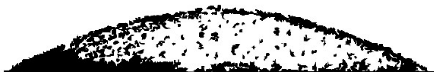
Hình F.4 - Cốt liệu gần như đã ở trạng thái sấy khô trong tủ sấy, không có đỉnh, mặt ngoài gần như hình cong
