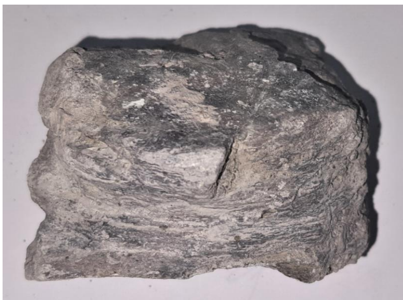
Hình 1. Hình ảnh mẫu đá sét bột kết thực tế
