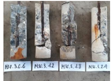
Hình 3.1. Khả năng bảo vệ cốt thép của bê tông W10(M300) với hàm lượng Cl - trong bê tông 0,6; 1,2; 1,8 và 2,4 kg/m 3
