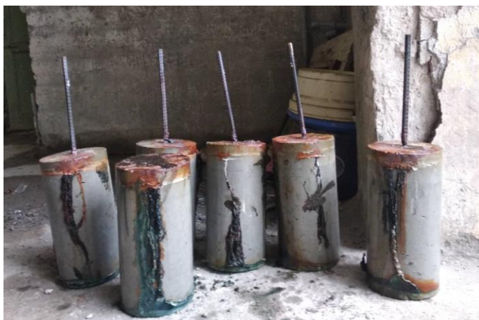
Hình 4. Các mẫu thí nghiệm sau khi bị ăn mòn điện hóa
