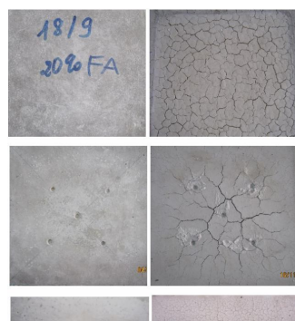
Tấm MPB-FA: trước (trái) và sau (phải) thử nghiệm ở 1200°C
