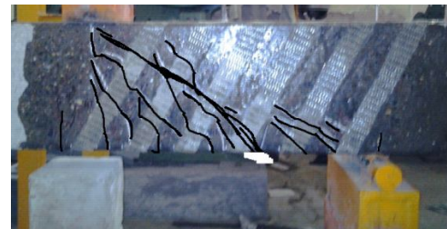
Hình 8. Sự phát triển của các vết nứt nghiêng ở dầm D3 (các vết nứt được tô đen)
