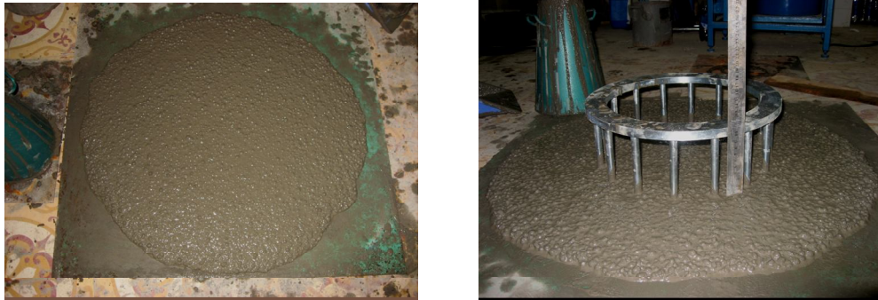
Hình 3. Hình ảnh thí nghiệm độ chảy tự do và độ chảy J-ring của HHBT
