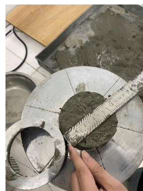
Hình 5. Xác định độ chảy của hỗn hợp bê tông in 3D trên bàn dần
