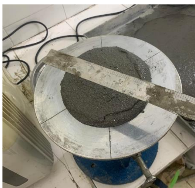
Hình 5. Xác định độ chảy của hỗn hợp bê tông in 3D trên bàn dần
