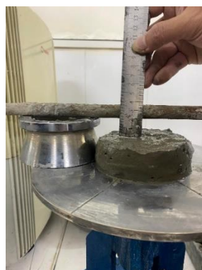
Hình 5. Xác định độ chảy của hỗn hợp bê tông in 3D trên bàn dần
