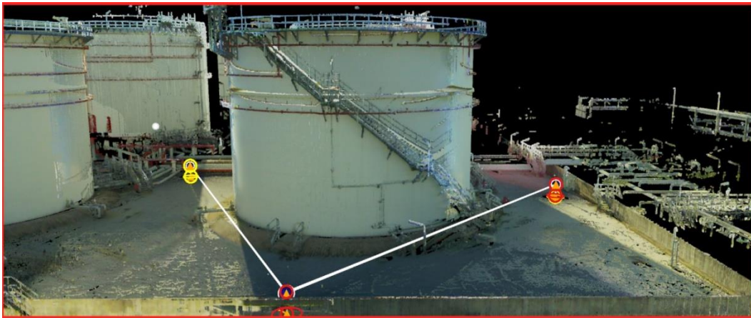
Hình 5. Dữ liệu đo dạng point cloud sau khi xử lý
