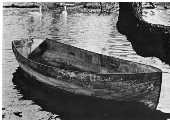
Hình 1. Ảnh tư liệu về chiếc thuyền làm từ vật liệu xi-măng lưới thép năm 1940 của Nervi [1]
