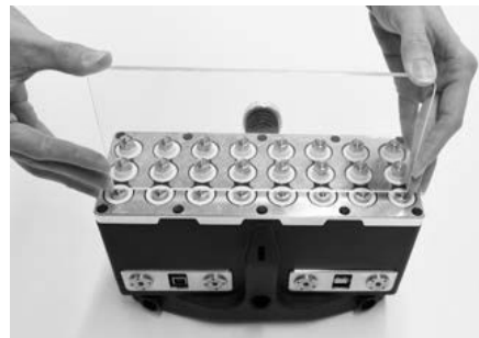
Hình 10. Kiểm tra đầu đo bằng thanh chuyên dụng trước khi siêu âm
