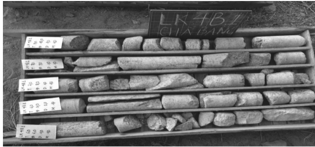
Ảnh 2. Đá granit phong hóa trung bình, đập vỡ mạnh (LK4B.1 từ 5 đến 10m)
