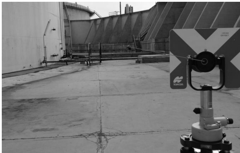
Hình 3. Thiết lập trạm máy trên công trình
