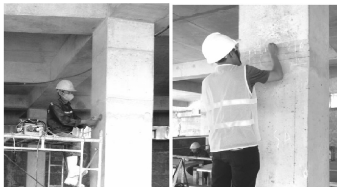
Hình 8. Mài phẳng bề mặt cấu kiện và kẻ lưới điểm đo
