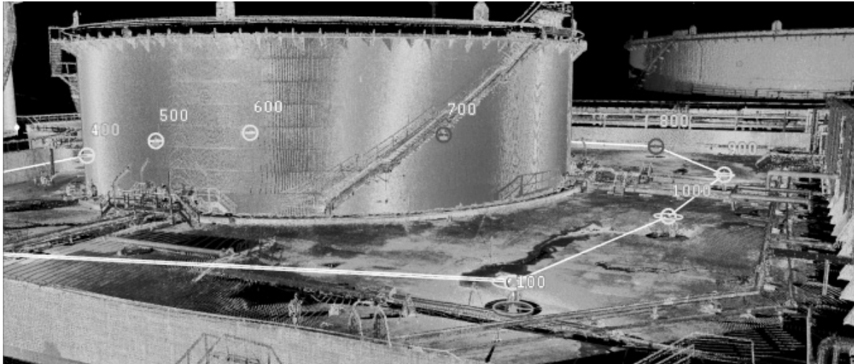
Hình 4. Dữ liệu scan được thực hiện bằng thiết bị GLS-2200, xử lý và hiển thị trên phần mềm MagnetCollage
