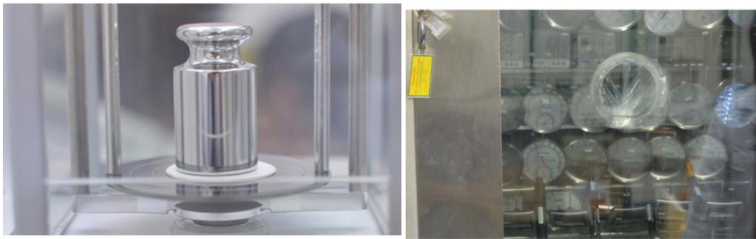
Hình 3. Quả cân chuẩn và tủ hiệu chuẩn nhiệt kế
