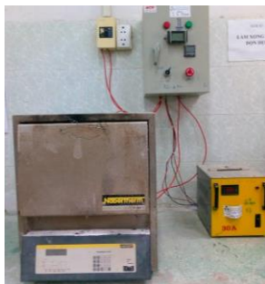
Lò nấu thủy tinh 1250^{\circ}C , lưu nhiệt 2giờ
