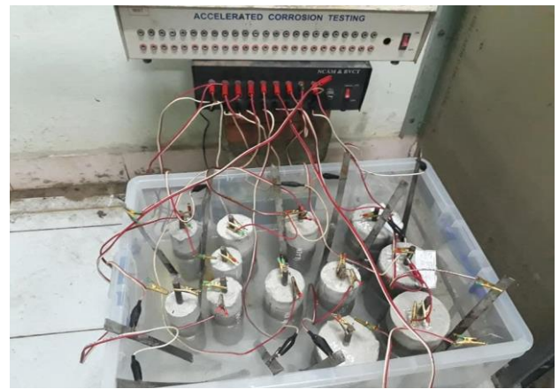
Hình 2. Thí nghiệm ăn mòn cốt thép bằng phương pháp gia tốc
