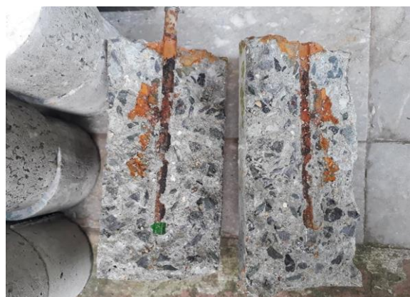
Hình 6. Bề mặt cốt thép khi phá mẫu
