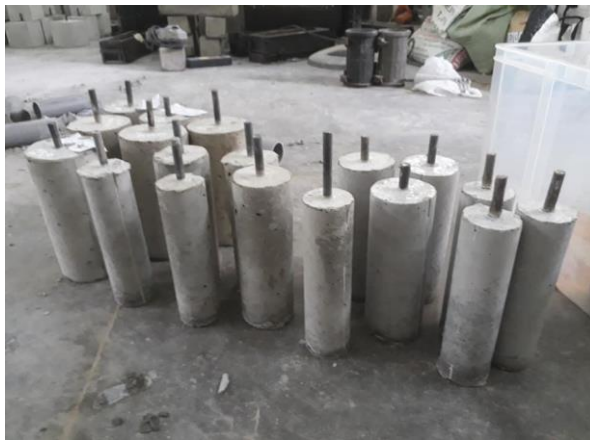
Hình 2. Thí nghiệm ăn mòn cốt thép bằng phương pháp gia tốc
