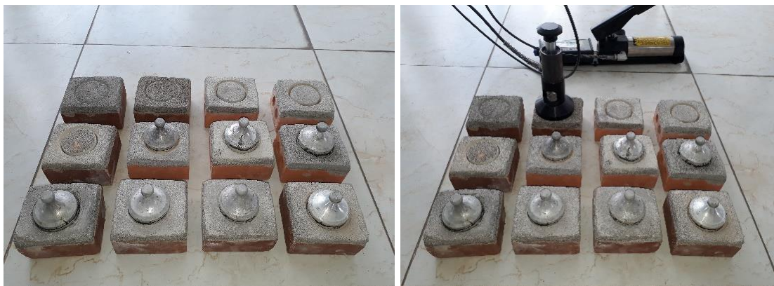
Hình 4.7. Thí nghiệm độ bám dính của vữa với nền gạch geopolimer
