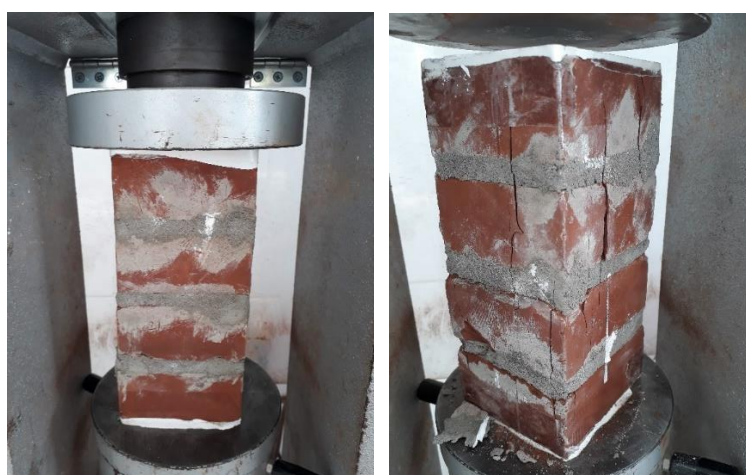
a) Bố trí thí nghiệm b) Dạng phá hoại khối xây
