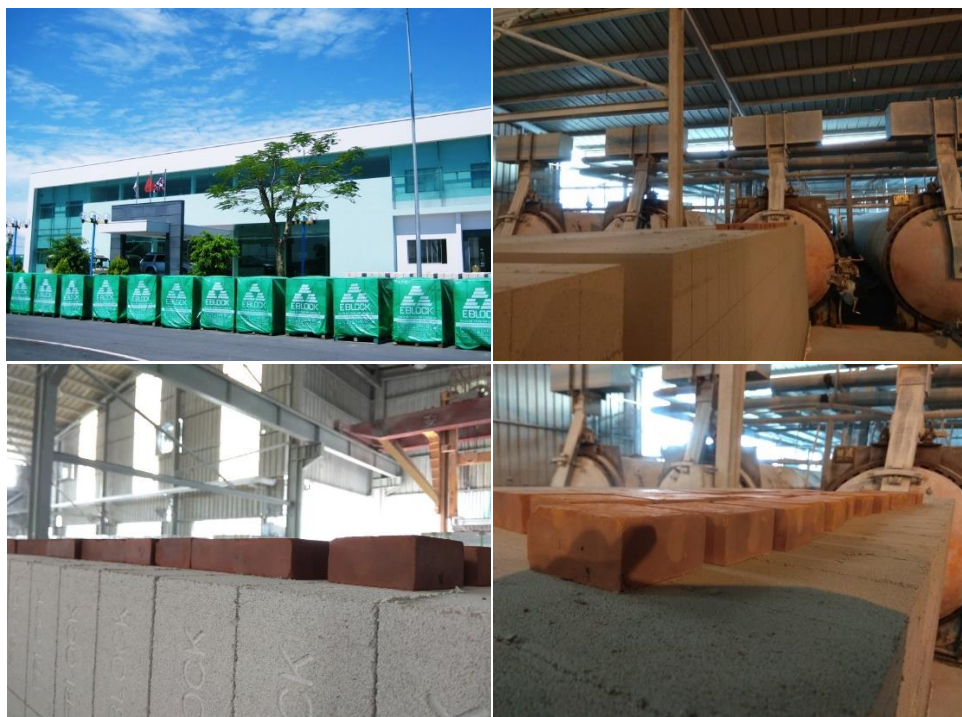
Hình 5.2. Chưng áp mẫu geopolymer tại nhà máy gạch khối Tân Kỹ Nguyên
