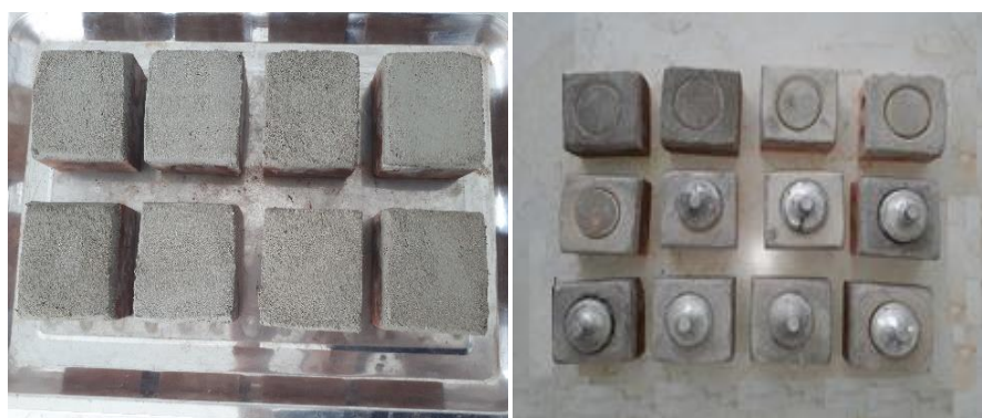
Hình 2.6. Hình ảnh thí nghiệm cường độ bám dính của vữa với gạch
