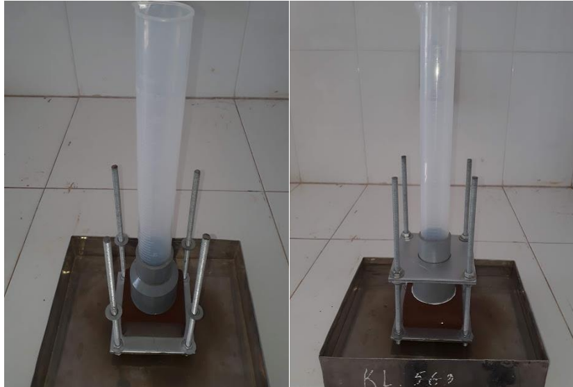
Hình 4.1. Thí nghiệm độ thấm nước của gạch
